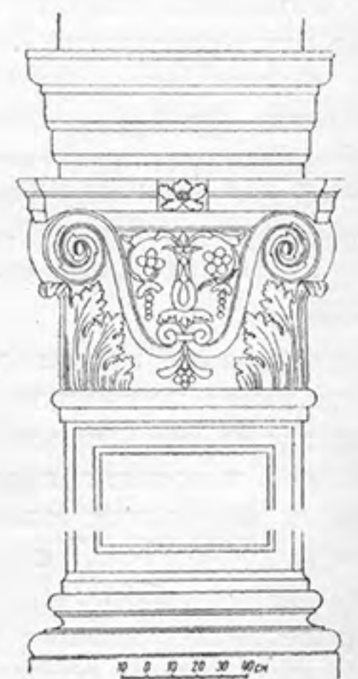
Рис. 22. Капитель северного фасада
