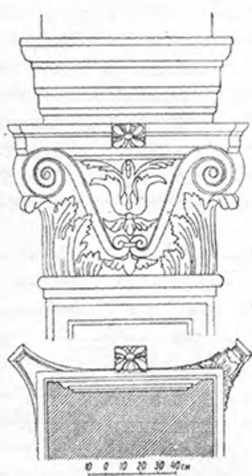
Рис. 20. Капитель северного фасада
